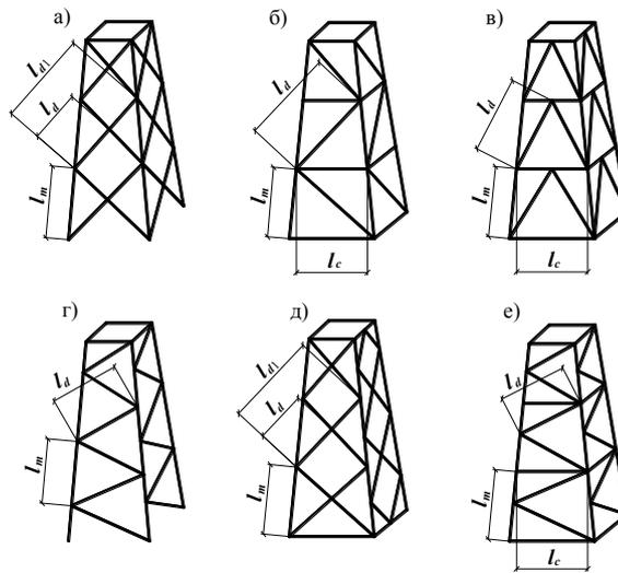
а, б, в – с совмещенными в смежных гранях узлами; з, д – с несовмещенными в смежных гранях узлами; е – с частично совмещенными в смежных гранях узлами
