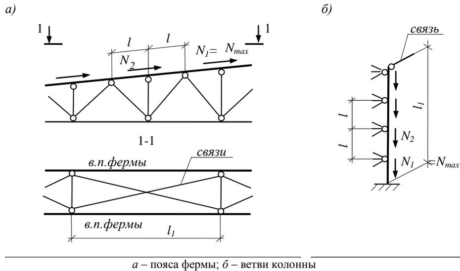
Рисунок 14 – Схемы для определения расчетной длины элементов
